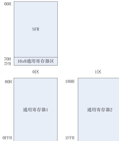
图 3.4 数据存储器地址映射图
