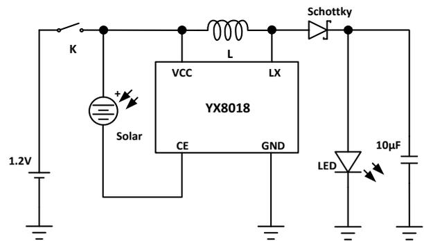
图 4. 太阳能电池控制使能
