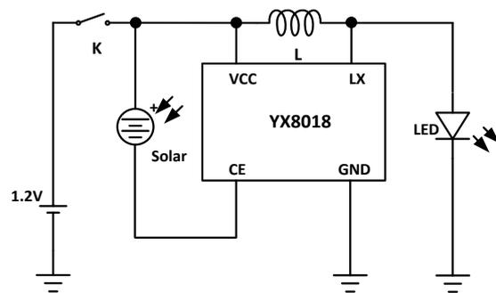
图 2. 太阳能电池控制使能
